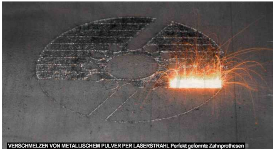
VERSCHMELZEN VON METALLISCHEM PULVER PER LASERSTRAHL. Perfekt geformte Zahnprothesen
