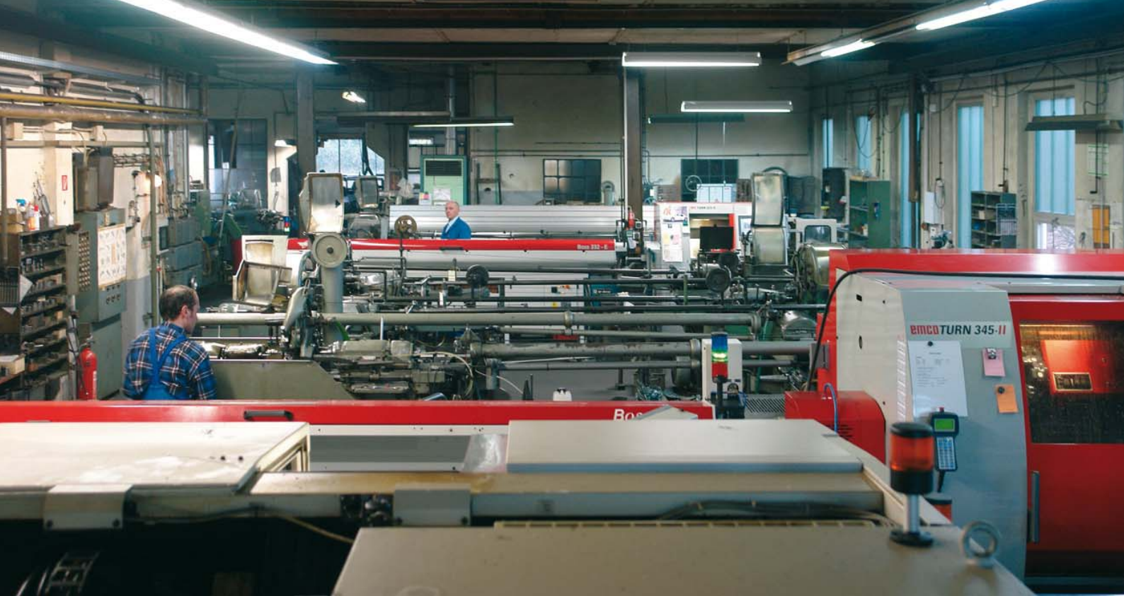
Bild 15: Angeschlossen werden kann die Werkzeugüberwachung an allen CNC-Maschinen. Vorn rechts im Bild das als erste mit dem Tool Monitor ausgerüstete Emco-Drehzentrum
