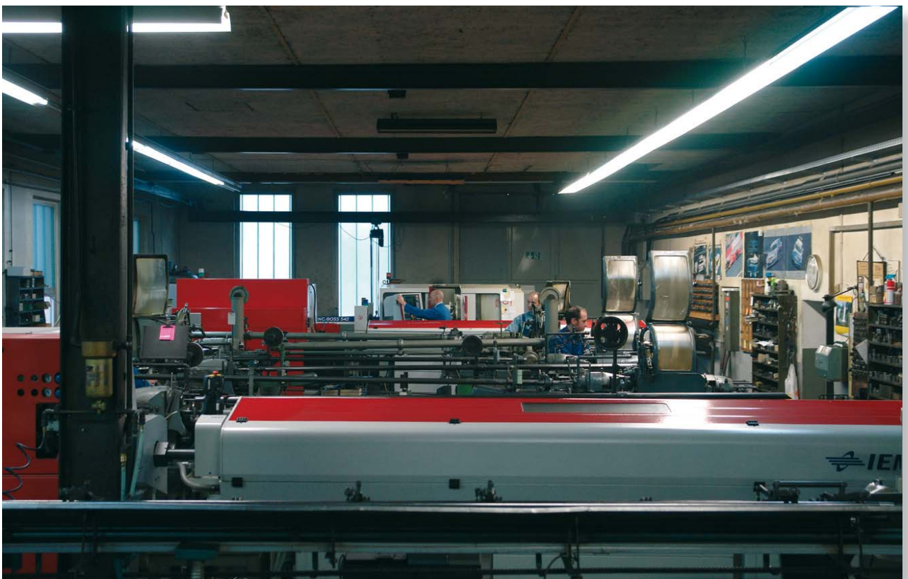
Bild 6: Gefertigt werden bei Müller+Guski Normdrehteile nach DIN, Sonderdrehteile, Muster- und Zeichnungsteile sowie DIN-Teile außerhalb der Normmaße. Die Formate der von der Stange bearbeiteten Teile liegen zwischen 1 mm und 65 mm Durchmesser
