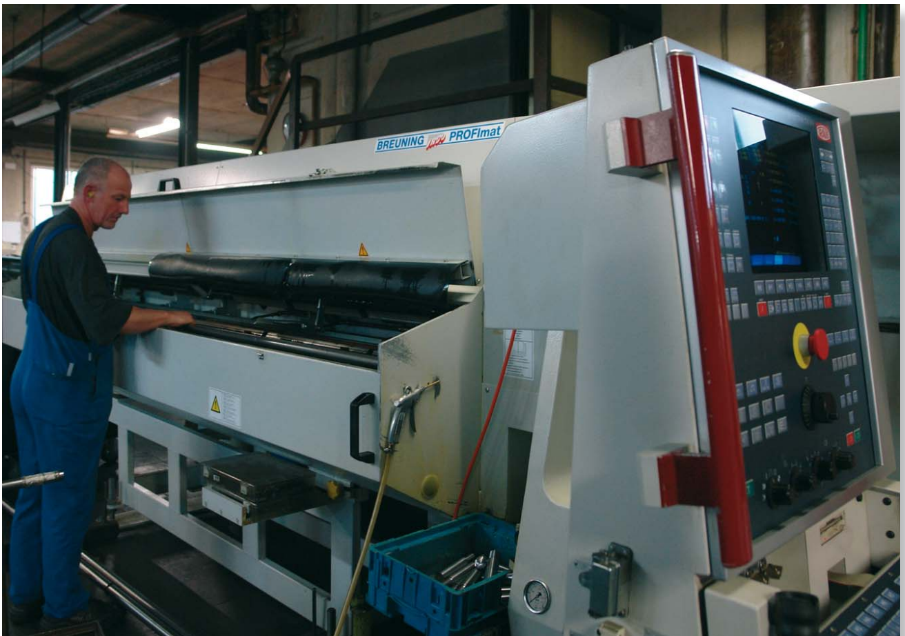
Bild 10: Wenn die Stangenlager der Drehmaschinen bestückt und die Mitarbeiter bereits im Wochenende sind, geht die Produktion bei Müller+Guski dennoch weiter
