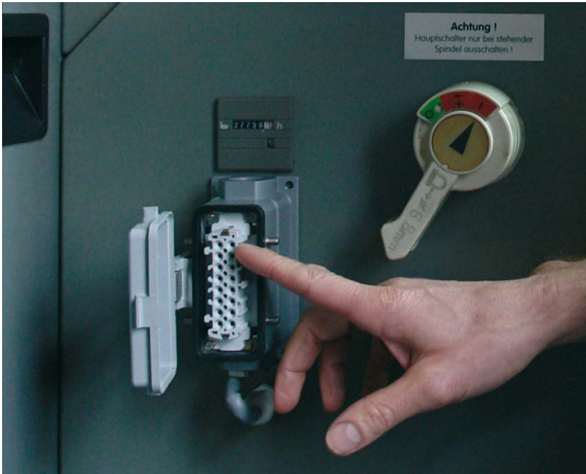
Bild 11: Über die 14polige Eurostecker-Schnittstelle lässt sich der Nordmann-Tool Monitor auch mit weiteren Werkzeugmaschinen verbinden
