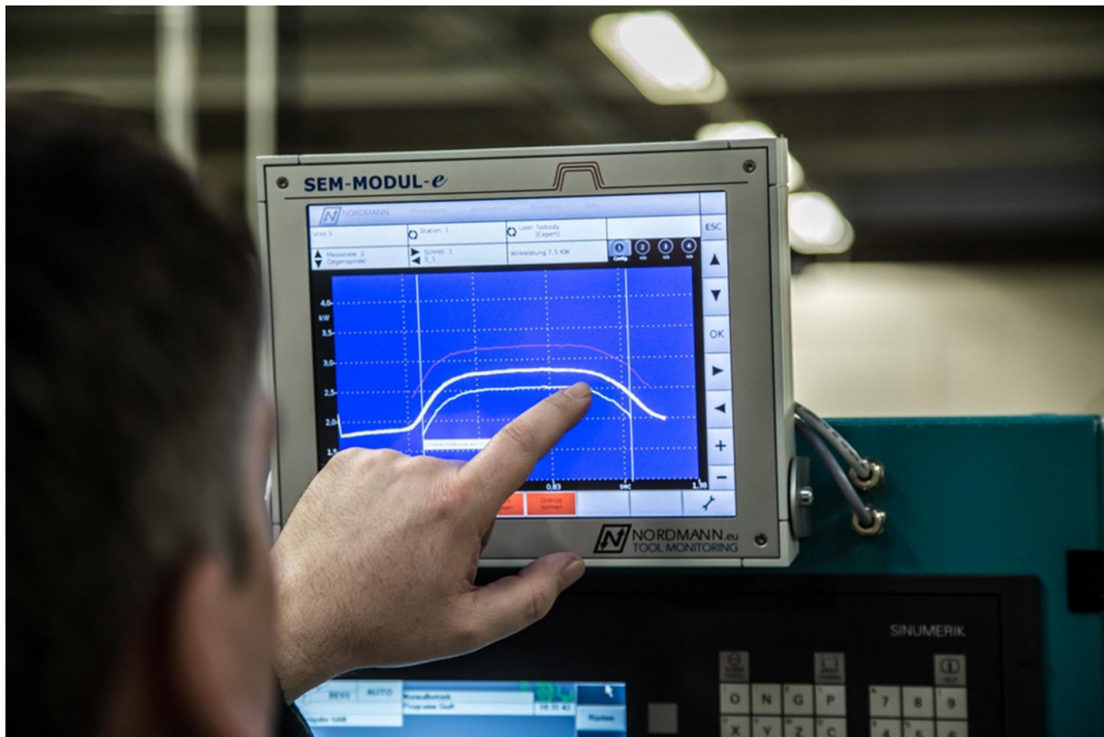
Das Touchscreen-Display ist eine Alternative zur Anzeige der Messkurven am NC-Bedienfeld © Nordmann
