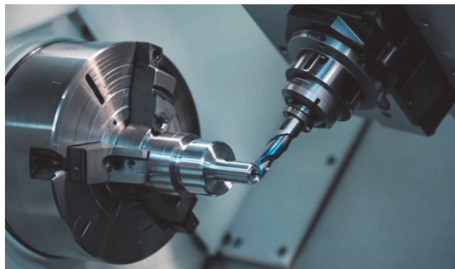
Bild 1. Um zu erkennen, wie hoch der Verschleiß eines Zerspanungswerkzeugs ist, beobachtet ein Überwachungssystem permanent den Werkzeugzustand der gesamten Maschine (Quelle: Nordmann)
