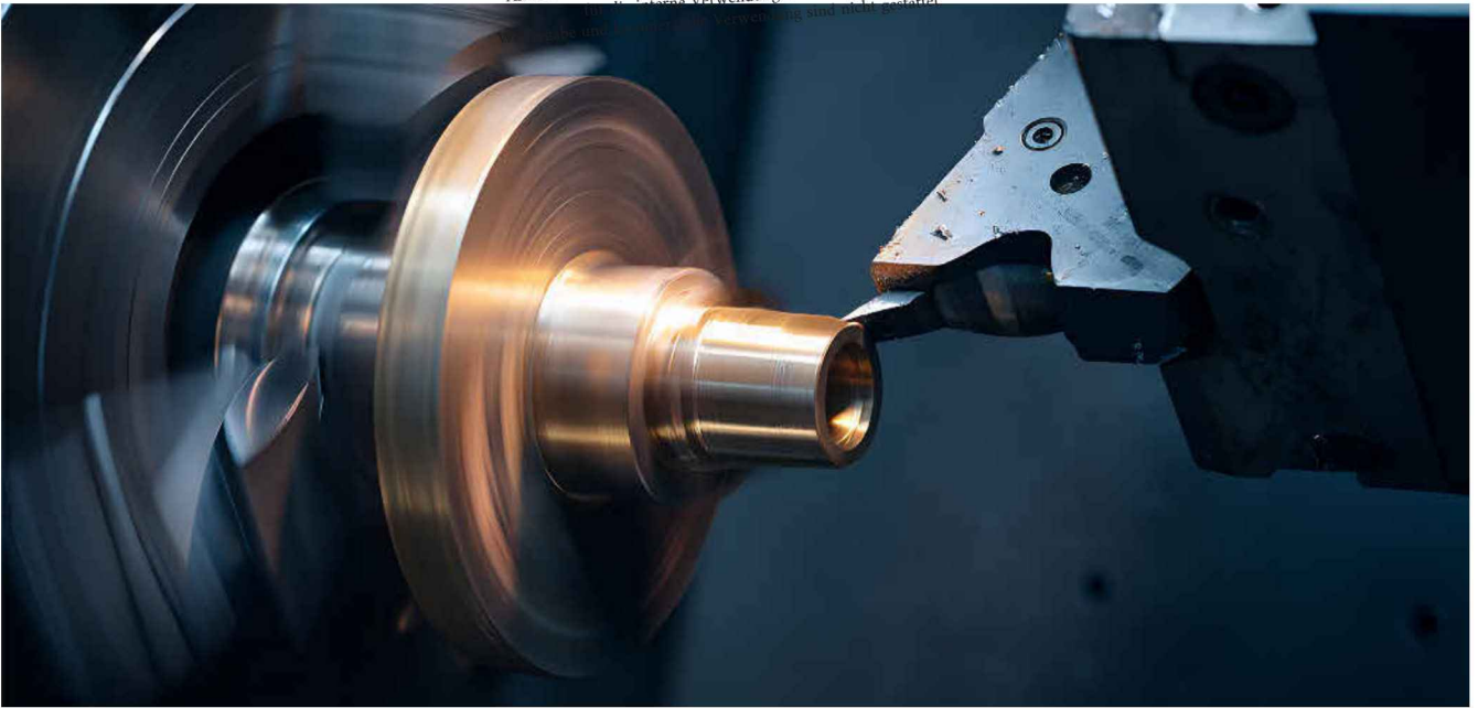
Blick in den Bearbeitungsraum einer Drehmaschine: Ein Werkzeugüberwachungssystem kann mittels unterschiedlicher Messtechniken genau voraussagen, wie groß der Werkzeugverschleiß bereits ist oder wann mit einer Materialermüdung der Schneiden zu rechnen ist. Foto: Nordmann
