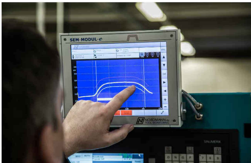
Bild 3. Die Einstellung der Hüllkurven-Grenzwerte ist anwendungsfreundlich am Touchscreen möglich. Foto: Nordmann
