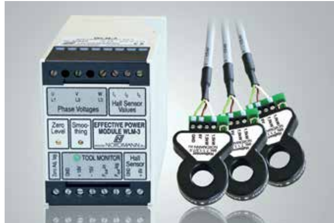
3 Das Wirkleistungsmessgerät WLM-3 – hier mit drei Stromsensoren – verbessert die Messwertqualität, indem es die Spannungen und Ströme der Drehstromantriebe misst, in die Wirkleistung umrechnet und an den Tool Monitor übermittelt (© Nordmann)
