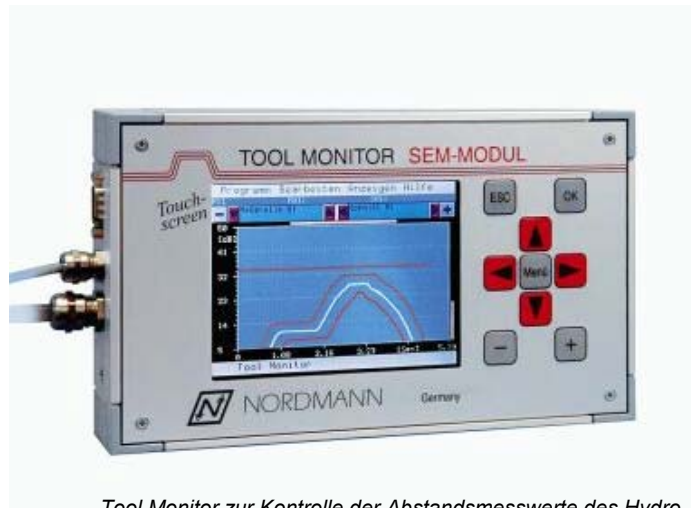
Tool Monitor zur Kontrolle der Abstandsmesswerte des Hydro-Distanzensors parallel oder im Wechsel mit der Wirkleistungsüberwachung
